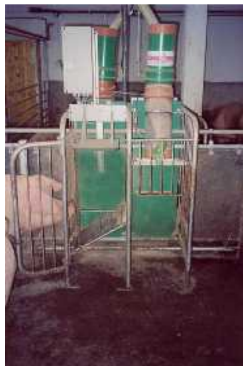
Obr. 3: Krmný box s dávkovací trubicí na kašovitě krmivo
