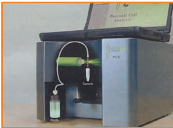
▲ Uvnitř „EasyCyte“ – spermie automaticky putují skrze mikrokapilární systém a jsou analyzovány
